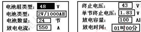
**注意:**在参数设置中，放电电流一项设置成所需要的电流 550A（设置值要大于额定电流才能并机成功）。其他参数设置与核对性放电设置一样。
