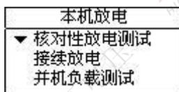
在此菜单中，通过↑/↓方向键移动光标选中核对性放电测试选项后，按【确认】键进入电池放电参数设置界面，界面如下：
