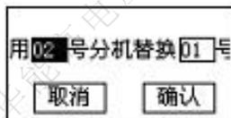
选择正确的备用分机号和故障分机号，按确定键就可以在放电过程中更换分机。
