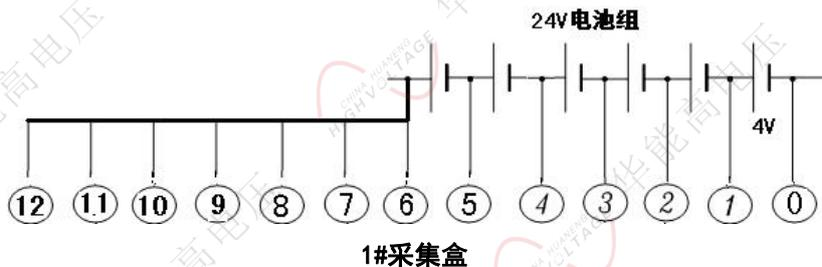
如果电池数超过每个采集盒能采集的相应电池数，则需要使用多个数据采集盒。则需要多个采集盒，下图是多个 12V 电池的连接方式，2V、4V、6V 电池连接同理：
