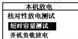
在本机放电菜单中，通过↑/↓方向键移动光标选中短时容量测试选项后，按【确认】键进入短时容量测试参数设置界面，界面如下：
