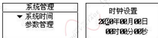
在系统时间设置界面中，通过↑/↓方向键选择要修改的项目，通过←/→方向键修改被选择的项目。
