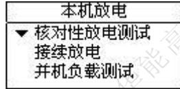
在本机放电菜单中，通过↑/↓方向键移动光标选中核对性放电测试选项后，按【确认】键进入放电参数设置界面，界面如下：
