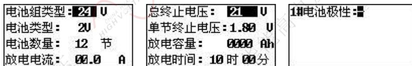
在电池放电参数设置界面中，通过↑/↓方向键选择要设置的项目，通过←/→方向键修改被选择的项目。电池放电要设置的参数共有电池组类型、电池类型、电池数量、放电电流、总终止电压、单节终止电压、放电容量、放电时间、电池极性。其中，电池组类型有24/48/110/220V 4种选择。电池类型有2V/100AH、2V/200AH、2V/400AH、2V/500AH、2V/1000AH、2V/3000AH、12V/100AH、12V/200AH、12V/300AH 9种选择。电池数量被测电池组实际电池个数（当不用无线采集盒监测单节电池时，电池数量设为0即可）。放电电流是设定放电仪工作电流（设置范围0-300A）。终止电压是电池组电压终止值。单节终止电压是电池组中个单节电池电压的终止值（这两个终止电压设置一般是电池标称电压的0.9倍）。放电容量是电池组可放出容量的终止值。放电时间是本次放电时间长度。
