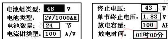
在外设放电参数设置界面中，通过↑/↓方向键选择要设置的项目，通过←/→方向键修改被选择的项。电池放电要设置的参数共有电池组类型、电池类型、电池数量、电流钳类型、总终止电压、单节终止电压、放电容量、放电时间 8 个。其中，电池组类型有 24/48/110/220V 4 种选择。电池类型有 2V/100AH、2V/200AH、2V/400AH、2V/500AH、2V/1000AH、2V/3000AH、12V/100AH、12V/200AH、12V/300AH 9 种选择。电池数量被测电池组实际电池个数（当不用无线采集盒监测单节电池时，电池数量设为 0 即可）。电流钳类型有 100A/V、200 A/V、400 A/V、800 A/V 4 种选择。终止电压是电池组电压终止值。单节终止电压是电池组中个单节电池电压的终止值（这两个终止电压设置一般是电池标称电压的 0.9 倍）。放电容量是电池组可放出容量的终止值。放电时间是本次放电时间长度。
