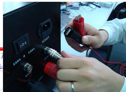
座，另一端红色测试夹连接蓄电池组正极，黑色测试夹连接电池组负极。注意不要接反！
