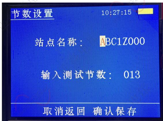
在【节数设置】界面下，按左右键选择站点编号和测试节数，按上下键可对选择的编号及测试节数进行设置，站点名称为26字母加0-9是个数字组合而成，测试节数最多可设置为999节。设置完成后，按确定键进入单节测试界面，进行指定节数的设置。
