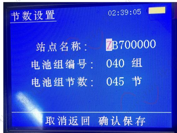
在【节数设置】界面下，电池组编号为系统自动生成，每进行一次整组测试自动加一。按左右按键可选择电池组节数及站点名称光标位置，上下按键可设置光标所对应的电池组节数及站点名称，站点名称支持全数字及全字母。电池组节数用户可自行根据实际电池组节数设置（必须与实际要测试的电池组节数相同）。按Enter键按当前设置的电池节数进入【连续测试】页面进行电池测试，按ESC键退出节数设置到【测试选择】界面。
