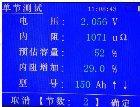
在【单节测试】界面下，按Enter键进行电池测试，节号表示当前所要测试的节数；电压显示被测电池电压值；内阻为被测电池内阻数值（单位 $\mu\Omega$ ）；容量为被测电池剩余容量百分比；通过上下键选择，
