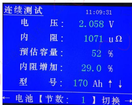
在【连续测试】界面下，按Enter键进行电池测试，按左右键可对已测试的电池进行查看，长按ESC键可对当前所在节数进行数据删除（删除当前节数数据后，必须重新测试被删除的电池数据）；节数表示要测试的下一节电池编号；电压显示被测电池电压值；内阻为被测电池内阻数值（单位 $\mu\Omega$ ）；容量为被测电池剩余容量百分比；通过上下键选择，选择被测电池的型号，内阻测试结束后，会自动进入系统冷却状态，冷却过程约15秒。冷却过程中，系统不能进行内阻测试，此时界面也会提示“冷却中”，冷却结
