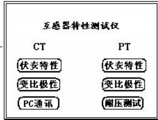
主菜单有 CT 伏安特性、变比极性、PC 通讯和 PT 伏安特性、变比极性和耐压测试六项可选项（如右图）。旋动旋转鼠标将光标移到某一项上，按下旋钮即可进入此项试验。
