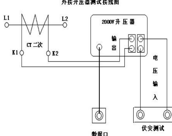
外部升压器后交流电压输出为 0~2000V。
