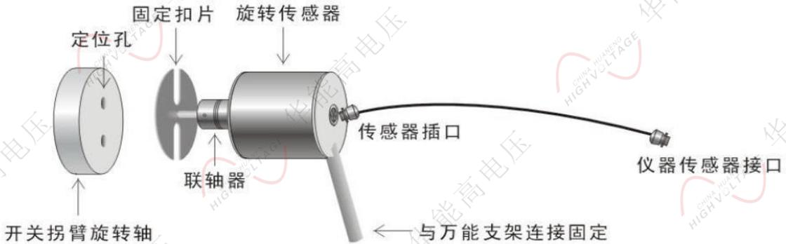
安装注意：旋转传感器的轴应尽量与开关旋转轴保持同心，否则传感器旋转有阻碍，测出曲线的毛刺会很重，影响测试数据的准确。
