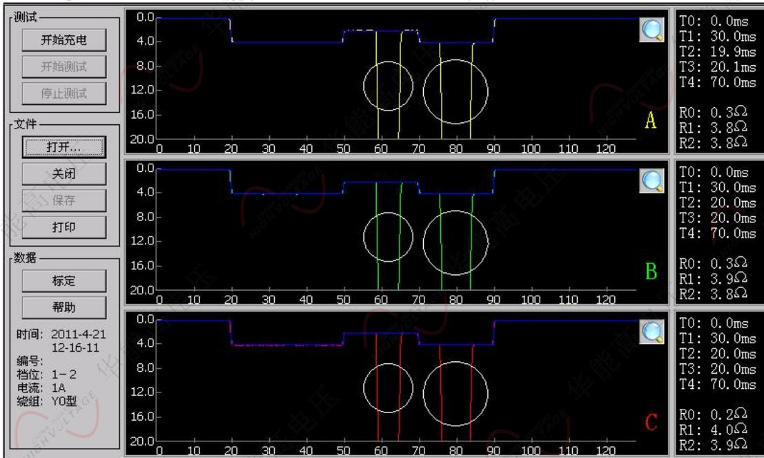
此图为变压器有载开关有断点的波形，白颜色的圆圈是提醒用户注意。
