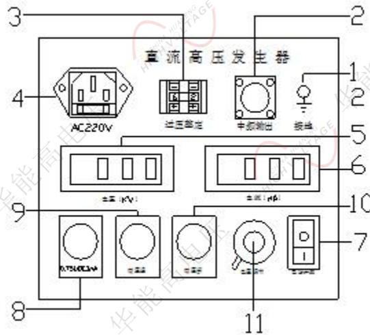
1. 控制箱接地端子：控制箱接地端子与倍压筒接地端子及试品接地联接为一点后再与接地网相连。
