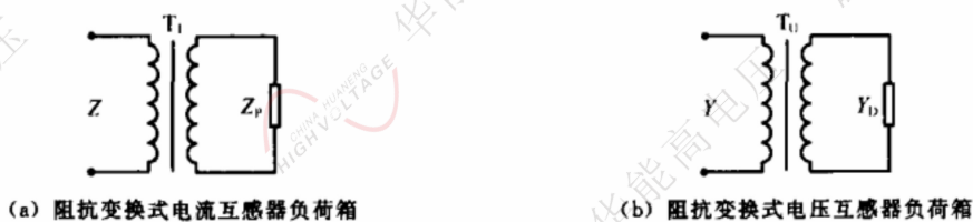
图 2 阻抗变换式互感器负荷箱原理线路
