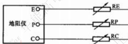
E—接地体端子；P—电压（电位）极端子；C—电流极端子； RE—标准器（等效接地电阻）；RC、RP—等效辅助接地电阻
