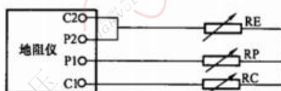
P1、P2—电压（电位）极端子；C1、C2—电流极端子； RE—标准器（等效接地电阻）；RP、RC—等效辅助接地电阻
