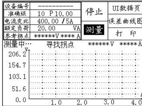
页面左上角为仪器测量进程显示，当不显示“等待测量”和“测量完成”时，表明仪器正在测量当中。在此过程中，请勿断开仪器和被测互感器的接线，以及切勿触摸被测互感器与测试夹！
