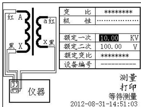
页面右下角为仪器测量进程显示，当不显示“等待测量”和“测量完成”时，表明仪器正在测量当中。在此过程中，请勿断开仪器和被测互感器的接线，以及切勿触摸被测互感器与测试夹！
