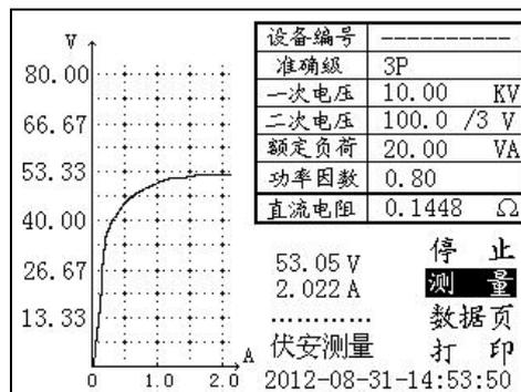
测量完成之后，进入“数据页”，可查询仪器自动调压的电压电流采样点，共二页 60 组的电压电流数据。
