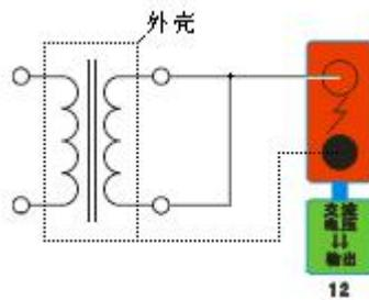
7. 接线图：图七 （二次直阻接线图）
