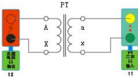
6. 接线图：图六 （二次耐压接线图）
