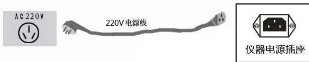
测试仪 AC220V 电源供电接线图
